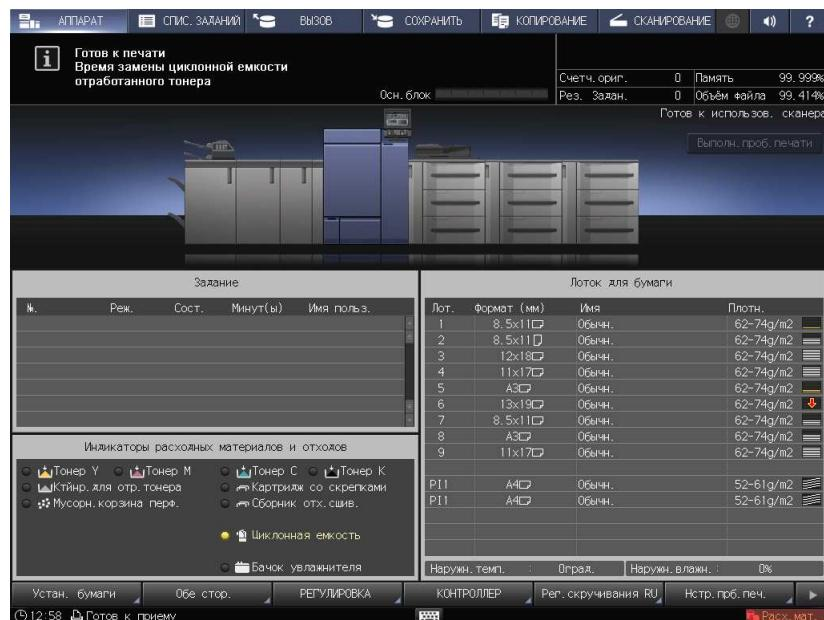
Если печать не может быть продолжена из-за необходимости замены **циклонной емкости**, на экране появляется сообщение [Замените циклонную емкость отработанного тонера]. При замене **циклонной емкости** следуйте указаниям ниже.
