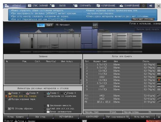
**3 Нажмите вкладку [Отраб.тонер], затем следуйте инструкциям в окне по замене контейнера для отработанного тонера.**
