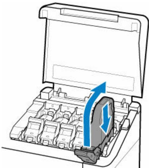
5. Нажмите на рукоятку фиксирующего рычага чернильного контейнера до упора.
