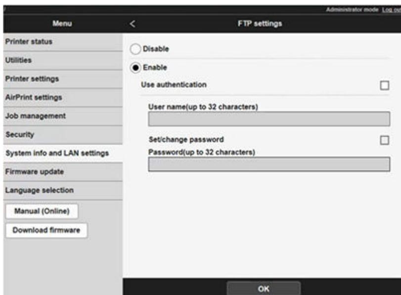
8. Установите флажки рядом с пунктами **Исп. провер. подлин. (Use authentication)** и **Уст./изм.пароль (Set/change password)**, а затем введите имя пользователя и пароль.
