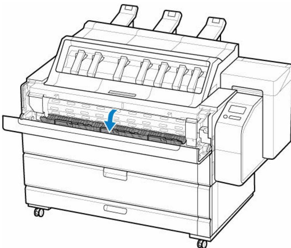
3. Для очистки внутренней поверхности (А) внутренней крышки модуля подачи используйте тщательно выжатую влажную ткань.
