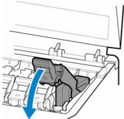
3. Нажмите на фиксирующий рычаг чернильного контейнера, пока он не будет закреплен.
