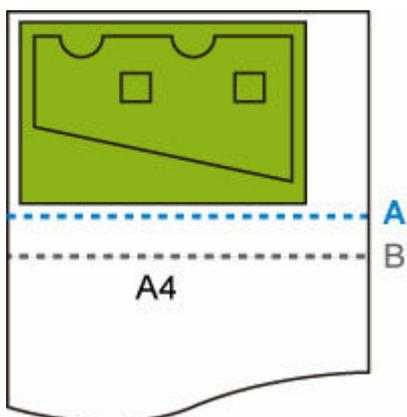
А. Линия обрезки при установленном значении **ВЫКЛ (OFF)**
