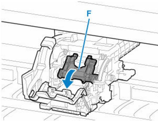
17. Удерживая фиксирующий рычаг печатающей головки за центральную часть (К), опустите его назад.
