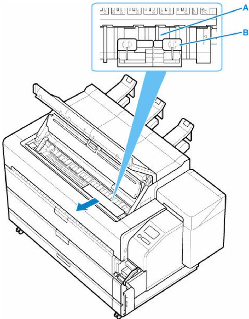
9. Отправьте вставленный лист на переднюю сторону устройства и вытащите его передний край из передней направляющей для выхода.
