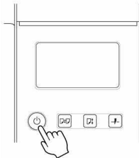
После загрузки загорится кнопка **ВКЛ**, и принтер перейдет в режим ожидания.
