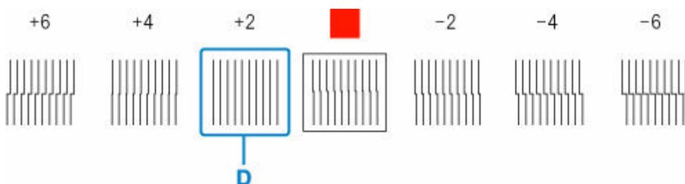
Пример 2. Переместите рычаг регулировки угла в положение между числами или между числом и квадратом (E), обозначающими два образца с наименьшими искривлениями. В этом случае выберите "-1".
