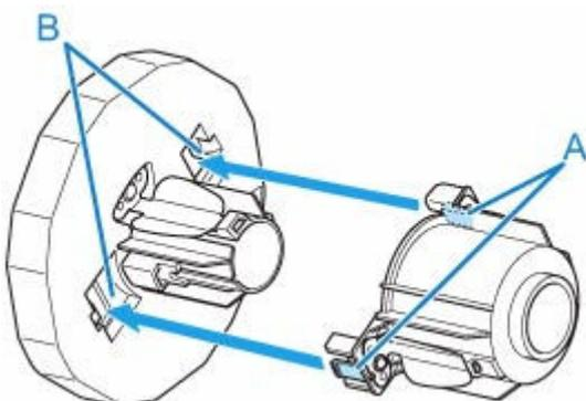
5. Вставьте ограничитель держателя слева в держатель рулона, как показано на рисунке, и удерживая в положении (B), нажмите, пока фланец ограничителя держателя (A) не коснется рулона. Зафиксируйте рычаг ограничителя держателя (C), повернув его в сторону
