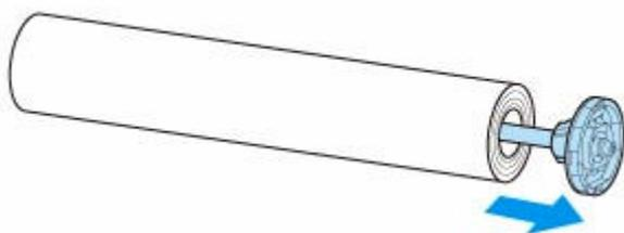
3. Чтобы извлечь стержневую насадку для 3-дюймовой бумаги, нажмите на выступы (А) внутрь и извлеките насадку.
