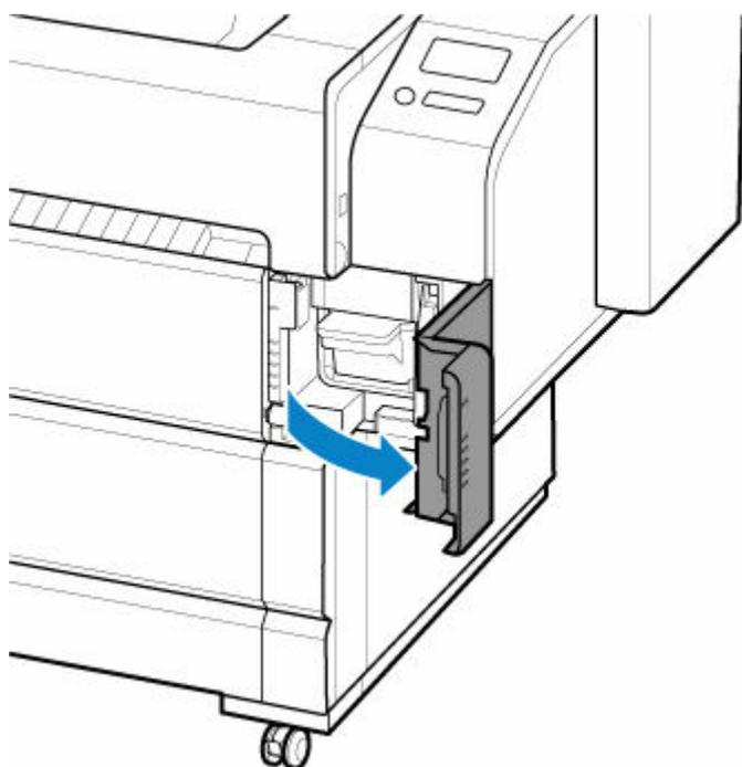
5. Поднимите спусковой рычаг.
