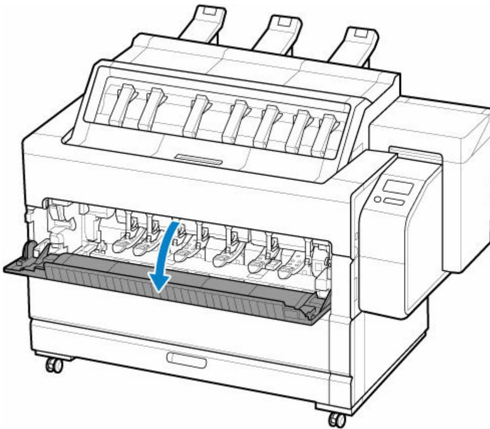
5. Для очистки внутренней поверхности (A) крышки для рулона используйте тщательно выжатую влажную ткань.
