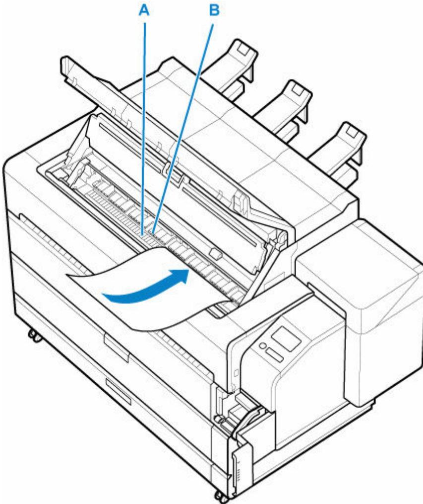
При размещении листа он автоматически прилипнет к поверхности валика.
