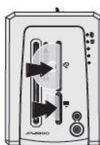
Вставьте пластиковую карту либо CD/DVD-диск в проем загрузки. Аппарат автоматически начнет работу
