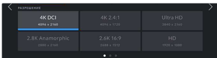
Опции разрешения на Pocket Cinema Camera 4K. Обратите внимание на то, что в формате 4K DCI категория называется «РАЗРЕШЕНИЕ», а в других форматах — «РАЗРЕШЕНИЕ И РЕЖИМ СЕНСОРА».
