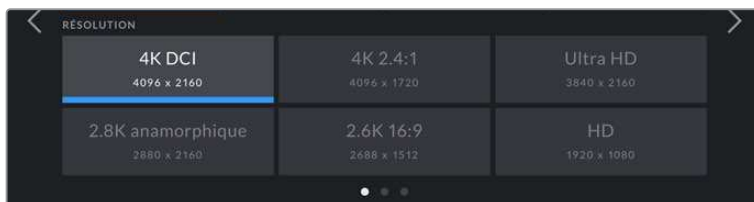
Options de résolution de la Pocket Cinema Camera 4K. En 4K DCI, la catégorie est Résolution, sinon elle sera Résolution - Capteur Window.
