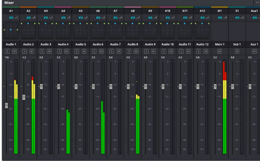
Timeline'deki ses kanalları ile eşleşen kanal şeritleri ile ses mikseri
