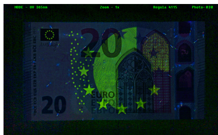
Сравнение исследуемой банкноты в ультрафиолетовом свете (365 нм) с эталоном из базы данных валют
