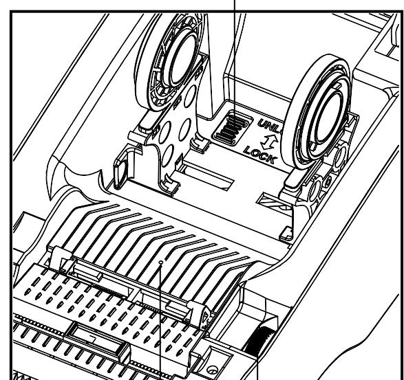
Датчик зазора (передатчик)
