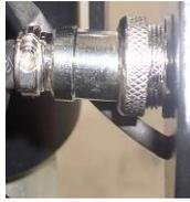
Открутите барашковую гайку при помощи которой крепится насадка, замените на нужную вам насадку и зафиксируйте с помощью гайки
