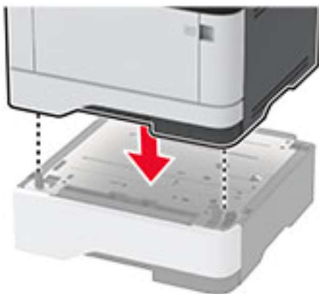
Рисунок 14 – Установка дополнительного лотка.
