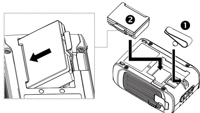
Loading Media/安裝標籤/安装标签/メディアの読み込み/Загрузка носителя/ Medien werden geladen/Chargement des medias/Cargando medios/Caricamento dei media/تحميل الوسائط
