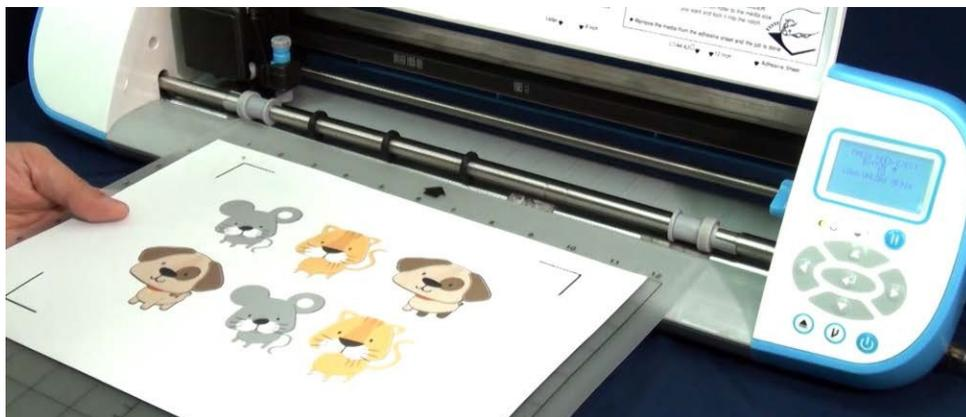
**Шаг 9** Нажать Next, затем на Scan+Cut. Плоттер i-Craft™ распознает метки реза и автоматически вырезает контурные линии.
