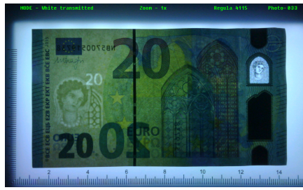
Сравнение исследуемой банкноты в белом донном свете с эталоном из базы данных валют
