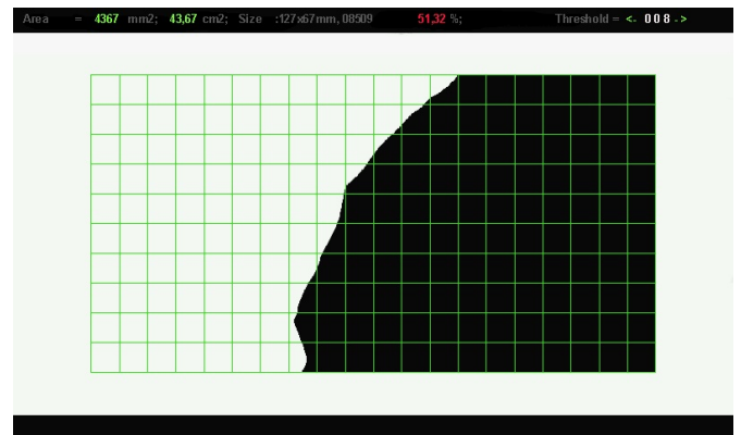
Автоматическое измерение площади (остаточной площади) банкноты
