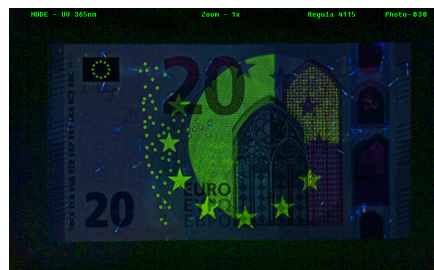
Сравнение исследуемой банкноты в ультрафиолетовом свете (365 нм) с эталоном из базы данных валют
