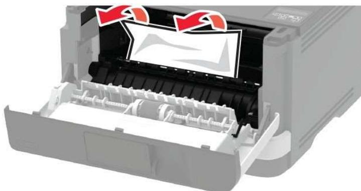
Рисунок 23 – Извлечение замятой бумаги из многоцелевого устройства подачи.
