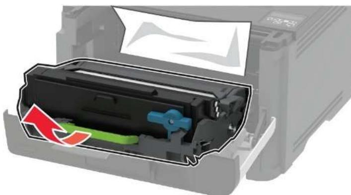
Рисунок 31 – Извлечение блока формирования изображения.
