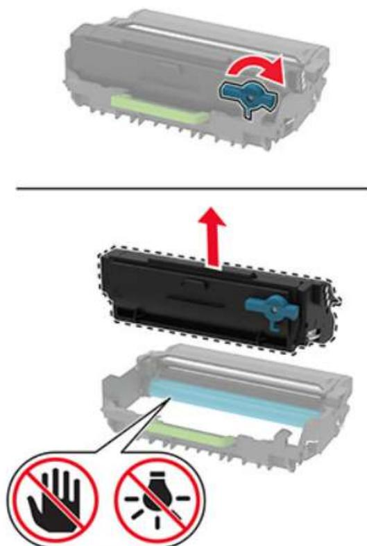
Рисунок 11 – Извлечение используемого картриджа с тонером.
