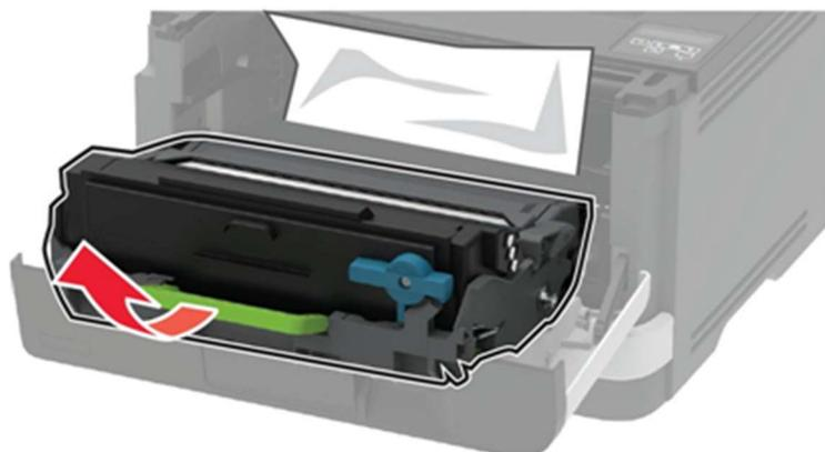
Рисунок 23 – Извлечение блока формирования изображения.
