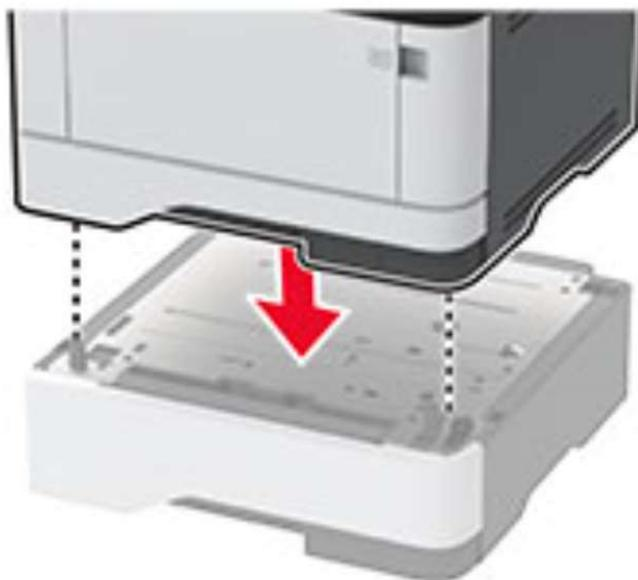
Рисунок 14 – Установка дополнительного лотка.
