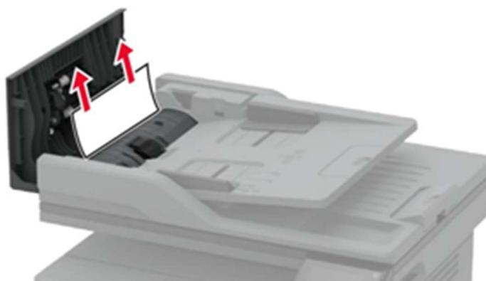
Рисунок 19 – Извлечение замятой бумаги.
