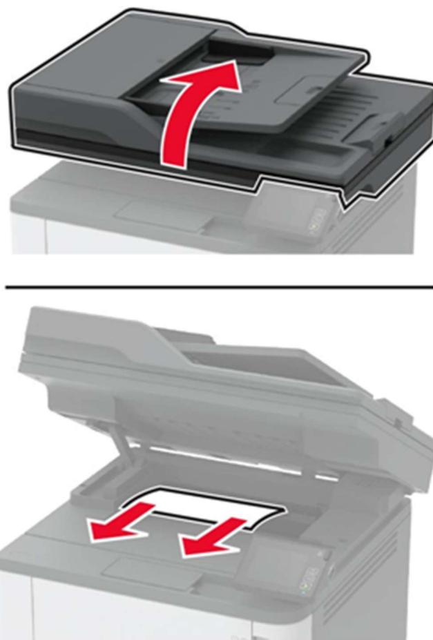
Рисунок 20 – Извлечение замятой бумаги в стандартном приемном лотке.
