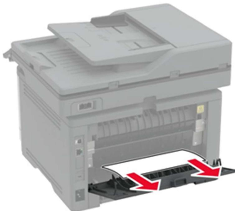
Рисунок 34 – Извлечение замятой бумаги.
