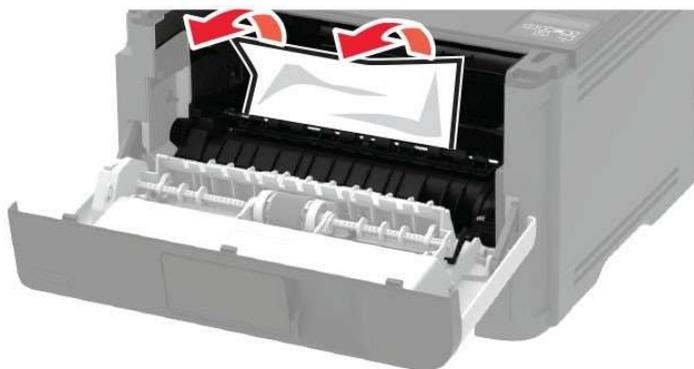
Рисунок 32 – Извлечение замятой бумаги
