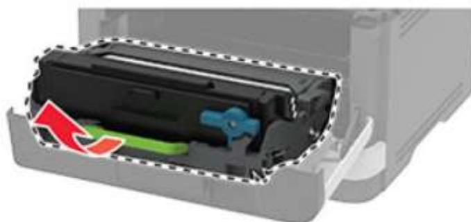
Рисунок 8 – Извлечение блока формирования изображения.
