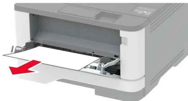
Рисунок 21 – Извлечение замятой бумаги из многоцелевого устройства подачи.
