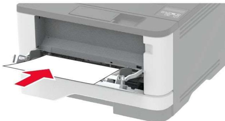
Рисунок 28 – Загрузка бумаги в многоцелевое устройство подачи.
