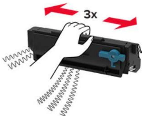
Рисунок 10 – Изображение встряхивания картриджа с тонером.
