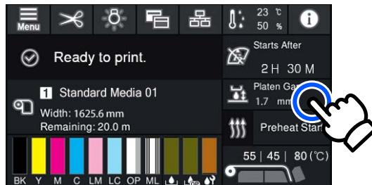
Рабочие области при нажатии выполняют какие-либо действия. Однако, как показано ниже, при отображении полосы прокрутки можно прокрутить экран, перемещая палец вверх и вниз по экрану. Можно также выполнить прокрутку, нажимая кнопки вверх и вниз на полосе прокрутки.
