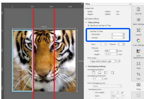
Пример: 2 фрагмента Horizontal (По горизонтали) и Vertical (По вертикали)
