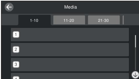
Если для **Управления носителем** выбрать зарегистрированный номер носителя, для которого не задан **Тип носителя**, отображается экран, где можно выбрать Тип носителя. Выберите Тип носителя, который соответствует загруженному носителю.
