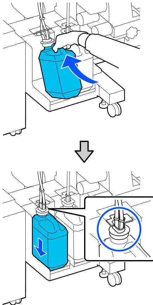
Тщательно запечатайте отверстие на использованной Waste Ink Bottle (Емкость для отработанных чернил).
