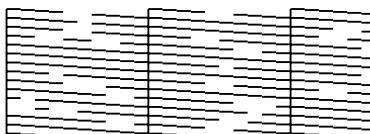
Если на шаблоне проверки дюз имеются пропуски, нажмите [**X**], после чего выполните процедуру Очистка печ. головки.
