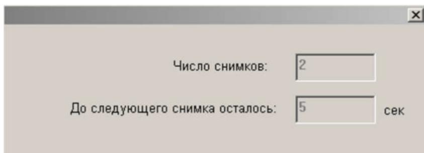
При завершении серии (кликнув **Стоп** или, что эквивалентно, нажав кнопки Photo на панели самого сканера или выносной USB кнопки) это окно останется на экране, что позволяет зафиксировать общее число полученных снимков текущей серии. После этого окно можно закрыть.
