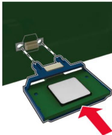
**Примечание:** Разъем платы микропрограммного обеспечения должен соприкасаться с системной платой по всей длине и располагаться в одной плоскости с ней.
