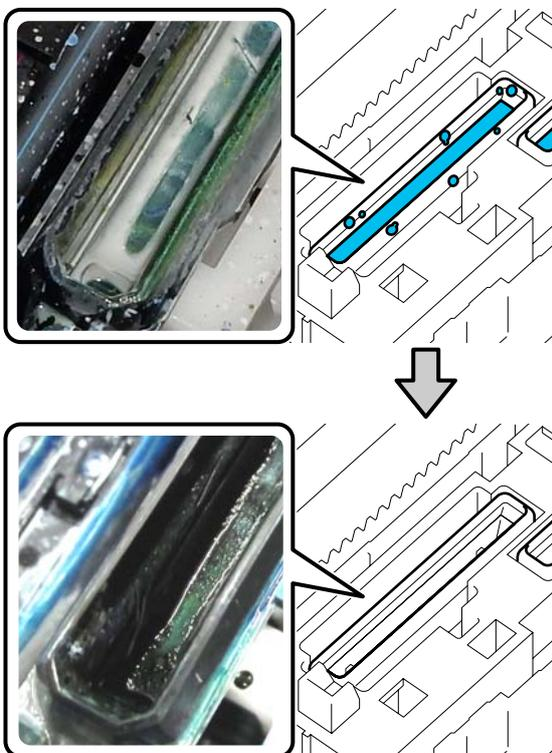
Скопление грязи по краям вызывает уменьшение силы всасывания. Если осталась грязь, смочите чистящую палочку чистящей жидкостью и повторите действия 7 и 8 для удаления грязи. Если в процессе очистки чистящая палочка загрязнилась, возьмите новую.
