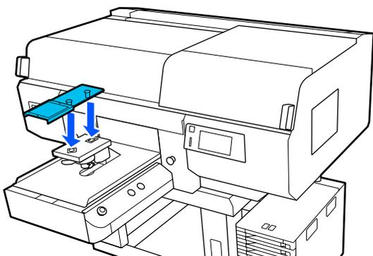
(2) Выровняйте фиксирующую ленту по выемке в верхней части печатного стола и плотно намотайте ее.
