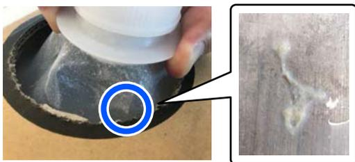
Это результат коагуляции фиксирующего компонента в жидкости для предварительной обработки. Если использовать жидкость для предварительной обработки с коагуляцией, результаты печати будут низкого качества. Поэтому необходимо отфильтровать жидкость перед использованием, чтобы устранить коагуляцию.
