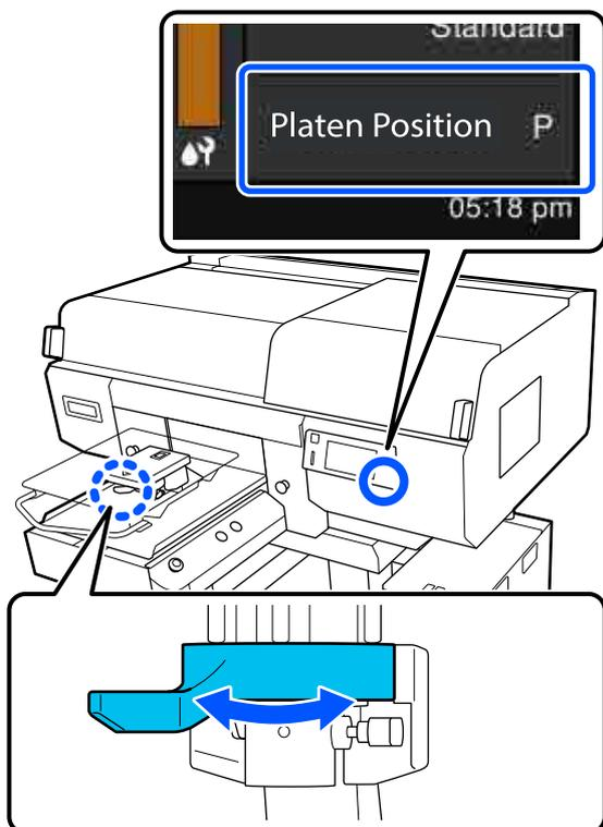
При повороте рычажка против часовой стрелки числа увеличиваются и высота расположения печатного стола уменьшается.
