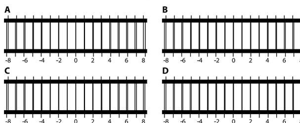
Проверьте 4 шаблона (от А до D) в каждом блоке и выберите позицию линии (от -8 до +8), которая на шаблоне выглядит самой тонкой (то есть составляющие ее линии накладываются друг на друга).
