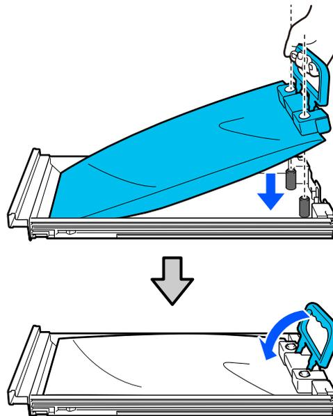
**5** Пока блок подачи чернил находится в лотке (см. рисунок ниже), осторожно встряхивайте его, наклоняя вверх и вниз примерно на 60 градусов, 5 раз в течение 5 секунд.
