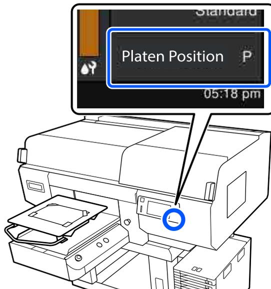
Если для параметра **Зазор валика** в разделе **Параметры носителя** установлено значение **Ручной**, измените его на **АВТО**.
