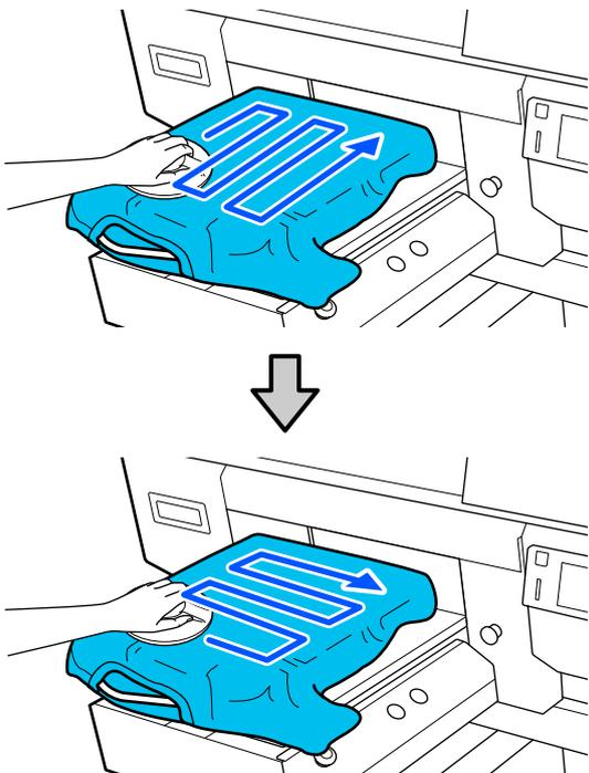
Если загружается футболка с нанесенной жидкостью для предварительной обработки или если разглаживатель цепляется за ткань, то при использовании разглаживателя поместите на футболку антиадгезионный лист, например силиконовую бумагу, как показано на рисунке.
