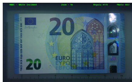
Сравнение исследуемой банкноты в белом верхнем свете с эталоном из базы данных валют
