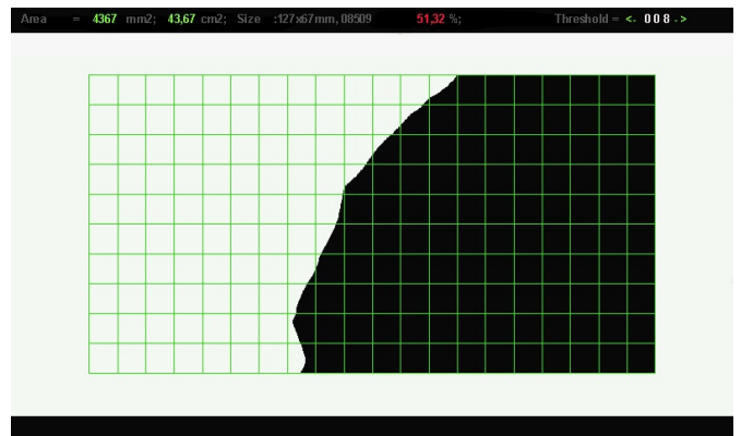
Автоматическое измерение площади (остаточной площади) банкноты
