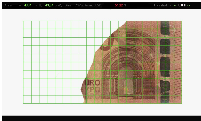
Автоматическое измерение площади (остаточной площади) банкноты
