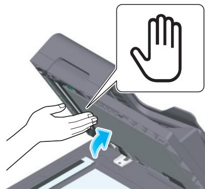
→ Нажмите на изображение руки в центре **открывающей и закрывающей направляющей** и проверьте, надежно ли зафиксировалась **открывающая и закрывающая направляющая**.
