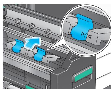
**11** Задвиньте устройство изготовлению брошюр.
