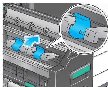
11 Задвиньте **устройство изготовлению брошюр**.
