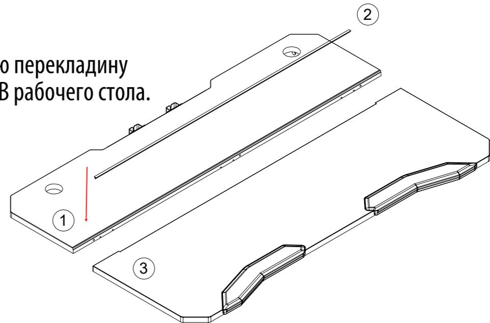
Вставьте установочный штифт С (x 3) в соответствующее отверстие и соедините части А и В столешницы с опорными профилями.
