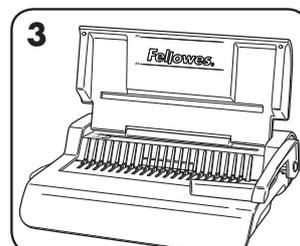
3. Lever le couvercle. Vérifier que le levier d'ouverture des anneaux en plastique est poussé vers l'arrière.
