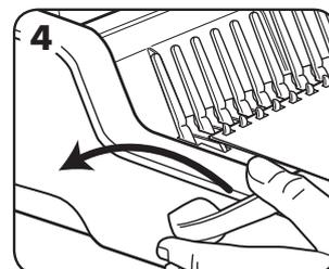
4. Când toate foile perforate sunt încărcate pe pieptene, împingeți maneta pieptenului înapoi pentru a închide pieptenele și îndepărtați documentul legat.
