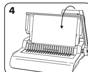
4. Procéder à un test de perforation de feuilles de brouillon pour vérifier le réglage de la butée de taillage.
