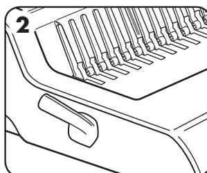
**2** Den Plastikamm in den Mechanismus einsetzen.
