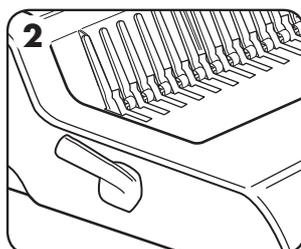
2. Zasuňte plastový hřeben do mechanismu.
