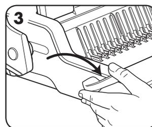
3. Tire de la palanca de apertura de canutillo hacia delante para abrir el canutillo.
