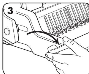
3. Povucite polugu za otvaranje zubaca prema naprijed da biste ih otvorili.
