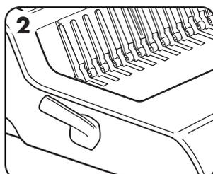
2. Insérer les anneaux en plastique dans le mécanisme.
