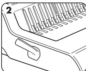
2. Introduceți pieptenele de plastic în mecanism.
