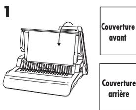
1. Perforer d'abord les couvertures avant et arrière.
