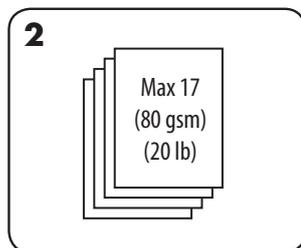
2. Perforați foile în serii mici, care nu supraîncarcă aparatul sau utilizatorul.
