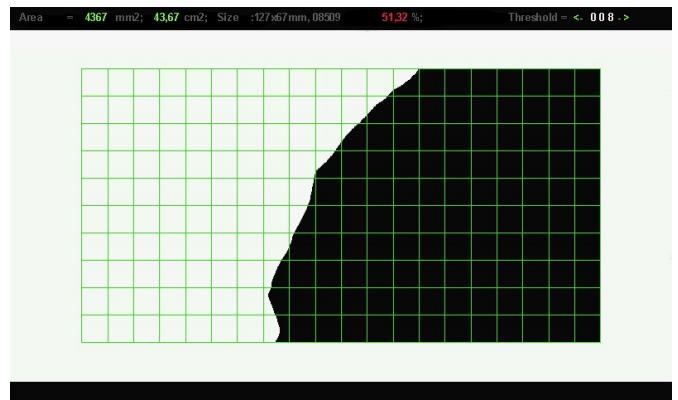
Автоматическое измерение площади (остаточной площади) банкноты
