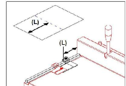
**2.2** Измерьте толщину переплетаемого блока , выставьте ограничитель № 1 в соответствии с полученной величиной и зафиксируйте его при помощи регулировочного винта .
