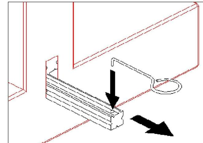
**3.2** Верхнюю и нижнюю планки нужно координировать друг с другом в соответствии со схемой расположенной выше. Неправильное соединение приведет к поломке планок
