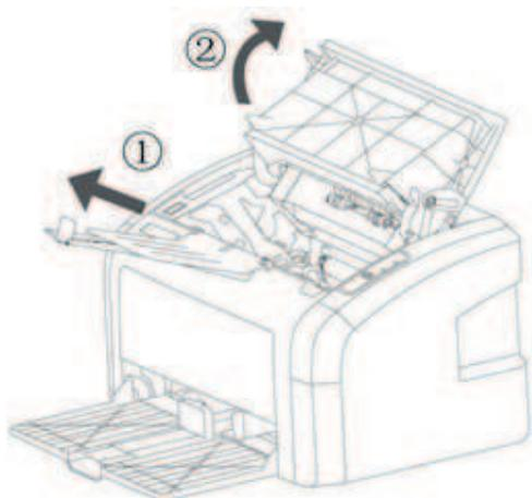
4. Вставьте картридж с тонером в принтер. Убедитесь, что картридж установлен на место (так, что его нельзя сдвинуть вниз или повернуть), а затем закройте верхнюю крышку.
