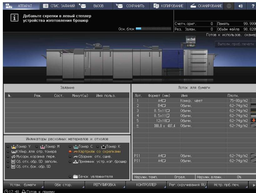
**1** Нажмите **[?]** в правом верхнем углу **сенсорной панели** или на **Помощь** на **панели управления** для отображения текста справки.
