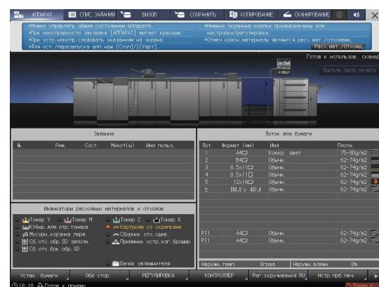
**3** Нажмите на вкладке [Добавл.сшив.] необходимого устройства изготовления брошюр, затем следуйте инструкциям в окне по замене картриджа со скрепками.
