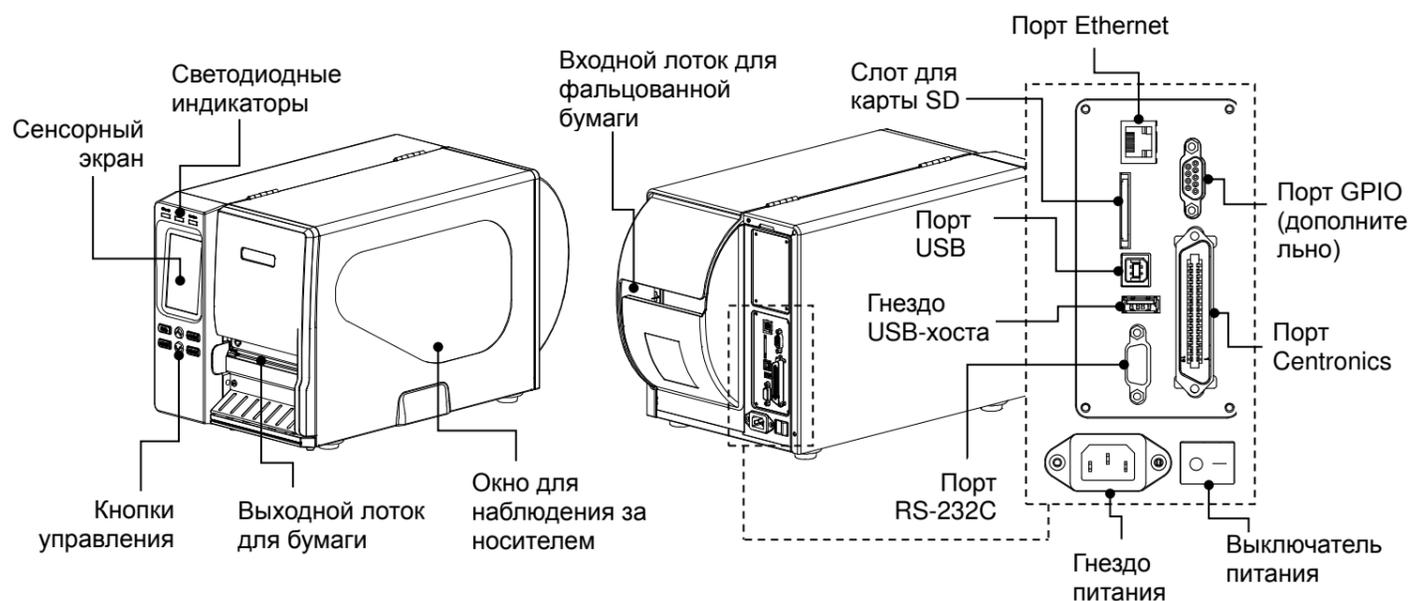
**Примечание** Порты показаны только для иллюстрации. Установленные на устройстве разъемы интерфейса см. в описании технических характеристик данного устройства.
