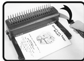
Рис.: 3 Вставьте бумагу в канал перфорации (макс. 12 листов 70-80г/м 2 за один раз) Потяните рычаг вниз до упора, чтобы полностью пробить
