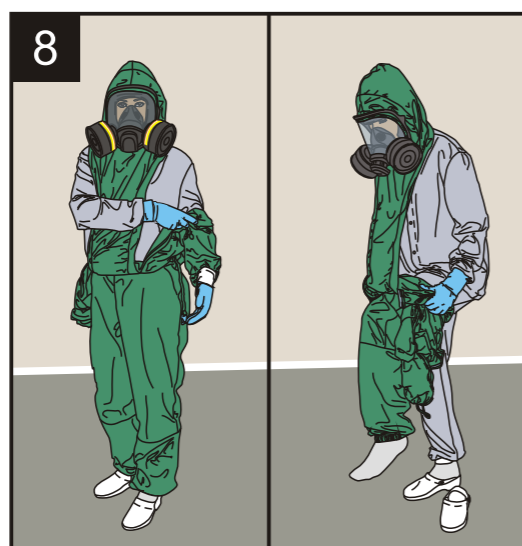
ШАГ 8 СНЯТЬ КОМБИНЕЗОН Снять комбинезон, выворачивая его наизнанку, при этом петля-держатель маски остаётся на шее для удержания комбинезона на весу. Когда сняты рукава и брючины комбинезона, петлю-держатель снять через голову не касаясь головы и тела.
