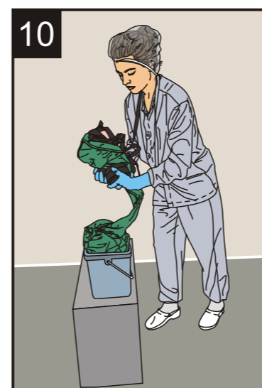
ШАГ 10 СНЯТЬ ФИЛЬТРЫ Держа маску над ёмкостью с дезраствором, поочередно отсоединить фильтры и сложить их в ёмкость для обеззараживания.
