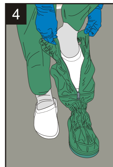
ШАГ 4 СНЯТЬ БАХИЛЫ Поднять наружную брючину, расстегнуть молнию и снять бахилы, отгибая борты изнаночной стороной наружу.
