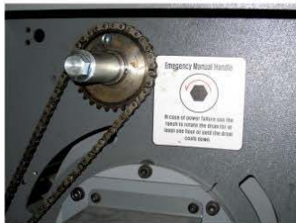
2. Механизм ручной прокрутки
