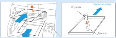
Датчик обнаруживает двойную подачу, и сканер немедленно прекращает процесс сканирования.
