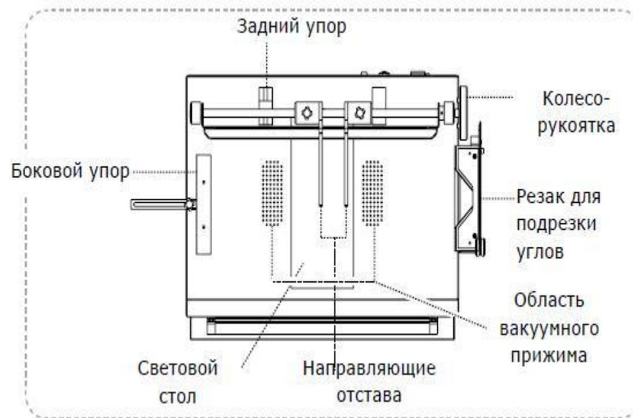
Перед изготовлением крышки отрегулируйте положение направляющих в соответствии с размером книги и расположением меток. Боковой и задний упоры используются для серийного производства крышек и при применении непрозрачного материала для обложки. На световом столе имеется измерительная шкала, которая помогает выровнять положение обложки. Отстав удобнее располагать относительно центральной линии. Область вакуумного прижима позволяет удерживать обложку при наложении сторонки.
