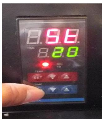
Нажмите **SET** на цифровой панели задачи параметров времени (нижняя панель), на верхнем цифровом экране загорится **SP**. С помощью кнопок **▲** и **▼** установите необходимое время. Чтобы зафиксировать данные удерживайте кнопку **SET** в течение 3 секунд
