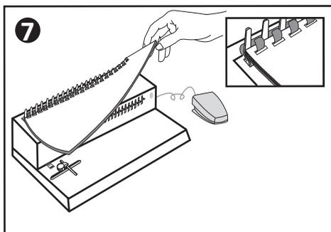
Снимите готовую брошюру с переpleтного механизма.
