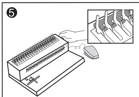
Используя ручку разжима пружины, разожмите пружину.
