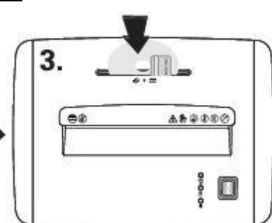
Вставьте пластиковую карту либо CD/DVD-диск в проем загрузки. Аппарат автоматически и начнет работу
