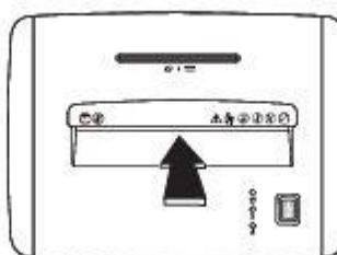
Нанесите смазочную жидкость
