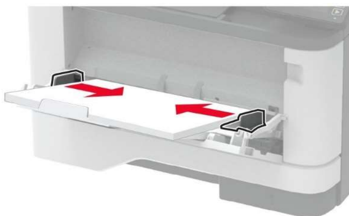
Рисунок 49 – Регулировка направляющих по формату бумаги.
