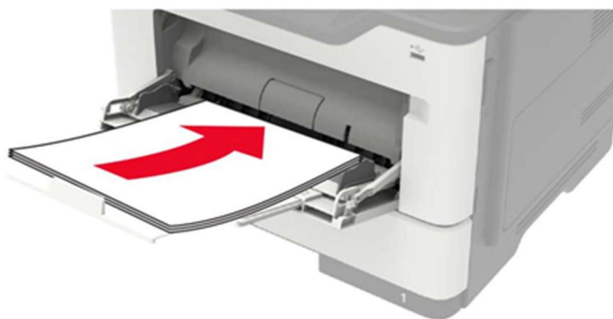
Рисунок 41 – повторная загрузка бумаги.
