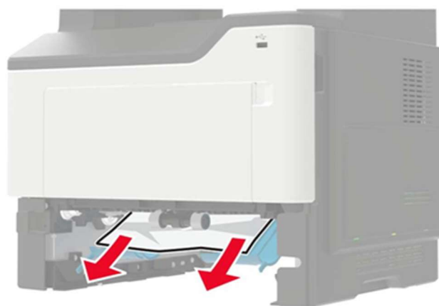
Рисунок 38 – Извлечение замятой бумаги.
