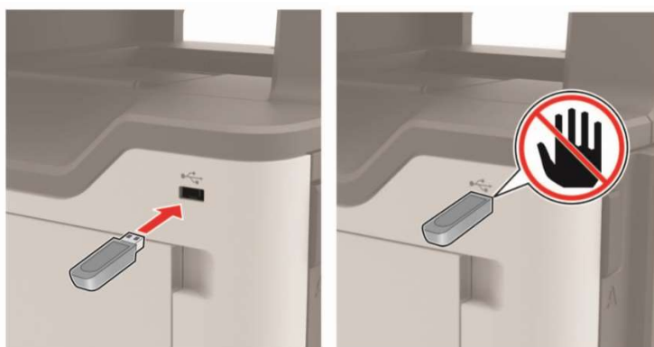
Рисунок 6 – Местонахождение разъема для флэш-накопителя.
