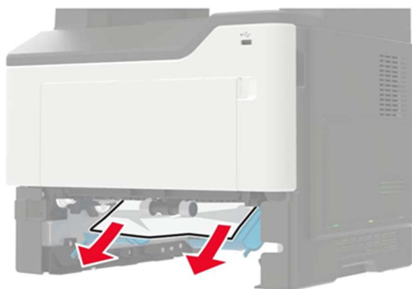
Рисунок 36 – Извлечение замятой бумаги.
