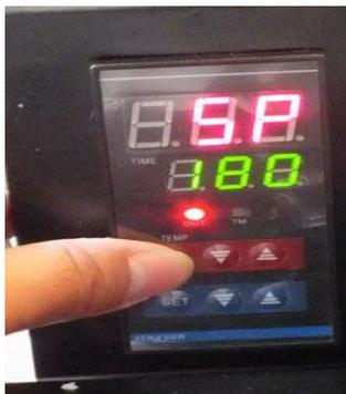
Нажмите **SET** на цифровой панели задачи параметров температуры (верхняя панель), на верхнем цифровом экране загорится «**SP**».
