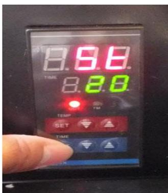
Нажмите **SET** на цифровой панели задачи параметров времени (нижняя панель), на верхнем цифровом экране загорится **SP**.
