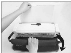
Рис.8 Опустите рукоятку вниз до упора чтобы закрыть пружину, затем верните в исходное положение. Выньте готовый буклет.
