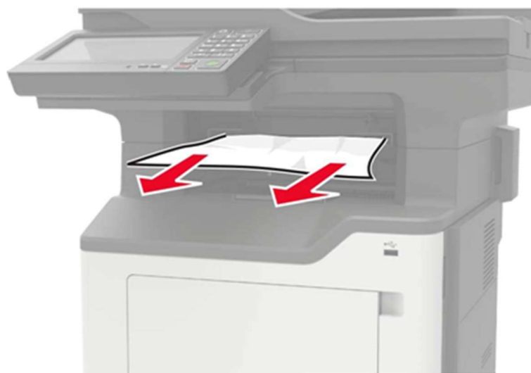
Рисунок 45 – Извлечение замятой бумаги.
