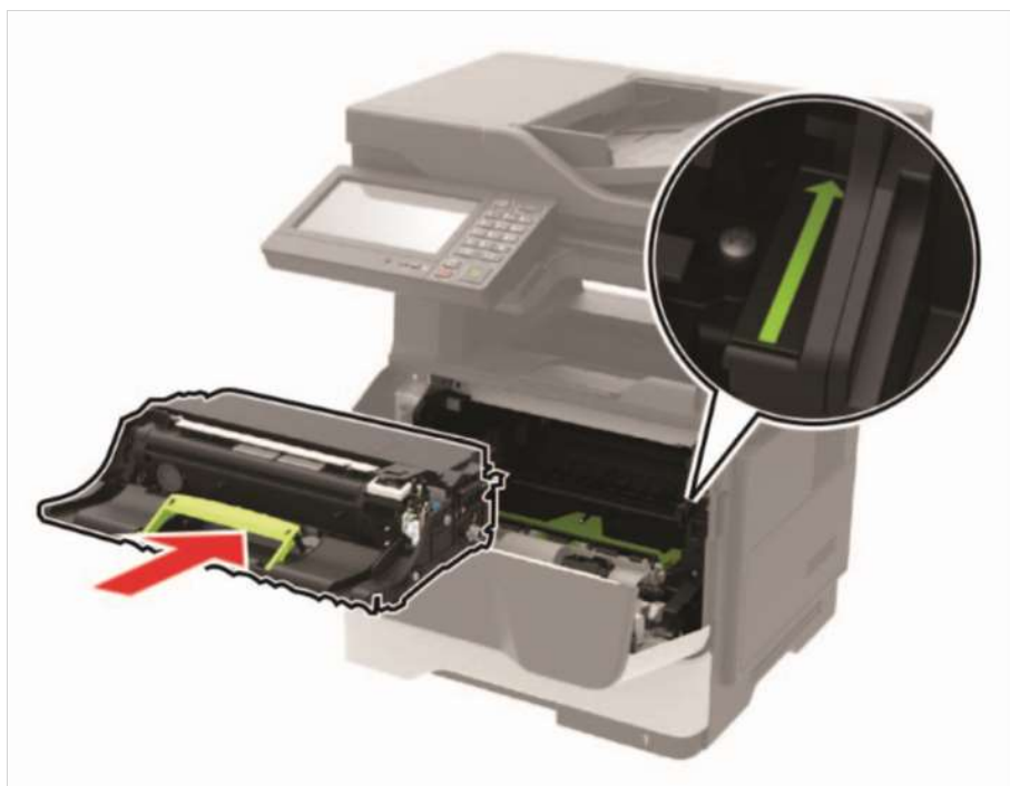
Рисунок 9 – Установка блока формирования изображения.
