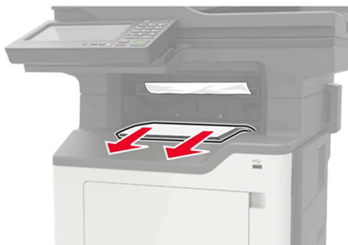
Рисунок 44 – Извлечение бумаги из лотка брошюровщика.
