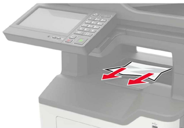
Рисунок 34 – Извлечение замятой бумаги.
