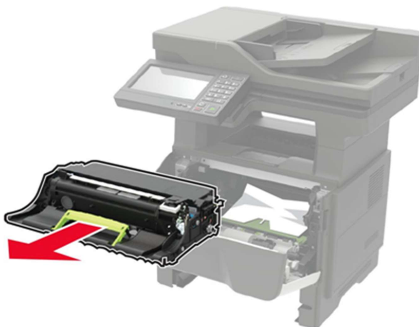
Рисунок 28 – Извлечение блока формирования изображения.
