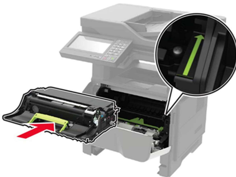
Рисунок 30 – Установка блока формирования изображения
