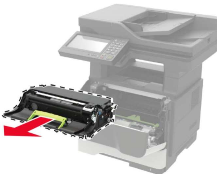
Рисунок 12 – Извлечение блока формирования изображения.
