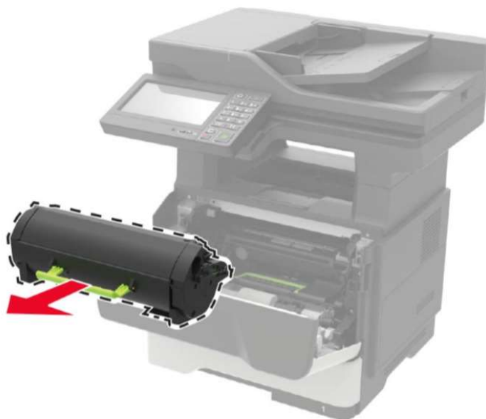
Рисунок 14 – Извлечение использованного картриджа.
