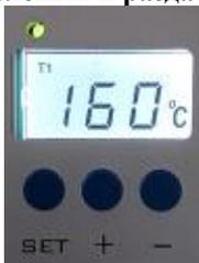
Для разогрева аппарата необходимо 15+25 минут (в зависимости от количества загруженного в клееподаватель термоклея и его марки).
