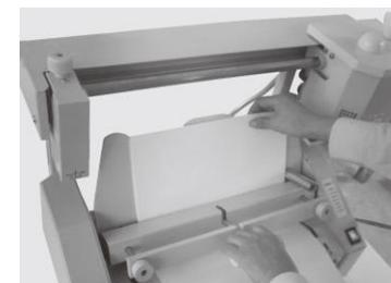
3. Придвинуть блок с обложкой вплотную к боковому упору. Подбить блок сбоку и сверху. Затем зажать блок, сдвинув пресс-зажим вплотную к блоку, зафиксировать блок отжав ручку пресс-зажима, при этом пресс-зажим следует придерживать левой рукой (см. рис.).
