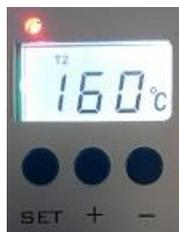
Если после перехода в другой режим дисплея долго не нажимать кнопку «SET», то пользователь автоматически будет возвращен в режим реального отображения температуры.
