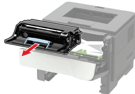
**Предупреждение—Возможность повреждения:** Не подвергайте узел формирования изображения прямому воздействию света в течение более 10 минут. Длительное воздействие света может привести к снижению качества печати.
