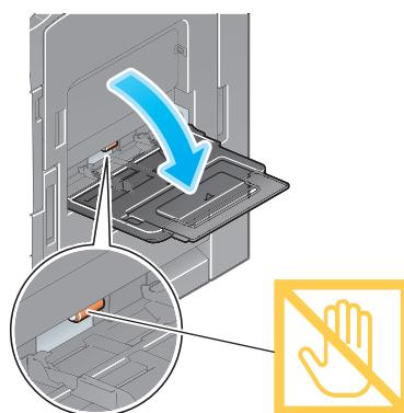
→ Чтобы загрузить бумагу большого формата, выдвиньте **выдвижную часть лотка**.
