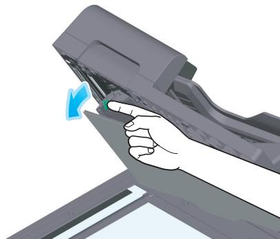
→ Расфиксируйте рычажок блокировки **открывающей и закрывающей направляющей** и откройте **открывающую и закрывающую направляющую**.
