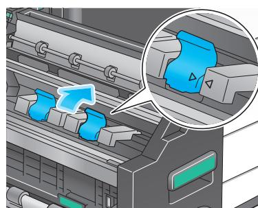
**11** Задвиньте устройство изготовлению брошюр.
