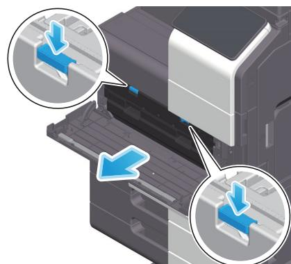
**3 Снимите очиститель печатающей головки с нижней передней дверцы аппарата.**
