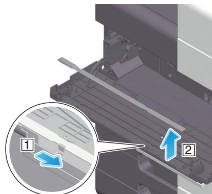
**4 Медленно вставьте очиститель печатающей головки до конца задней части стекла лазерного блока, а затем медленно вытяните назад.**
