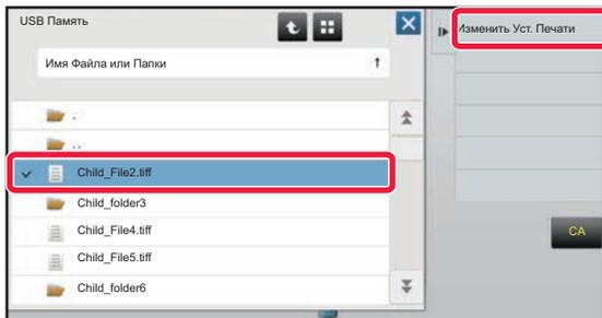
Коснитесь кнопки файла, который нужно напечатать, затем на панели действий коснитесь пункта [Изменить Уст. Печати].
