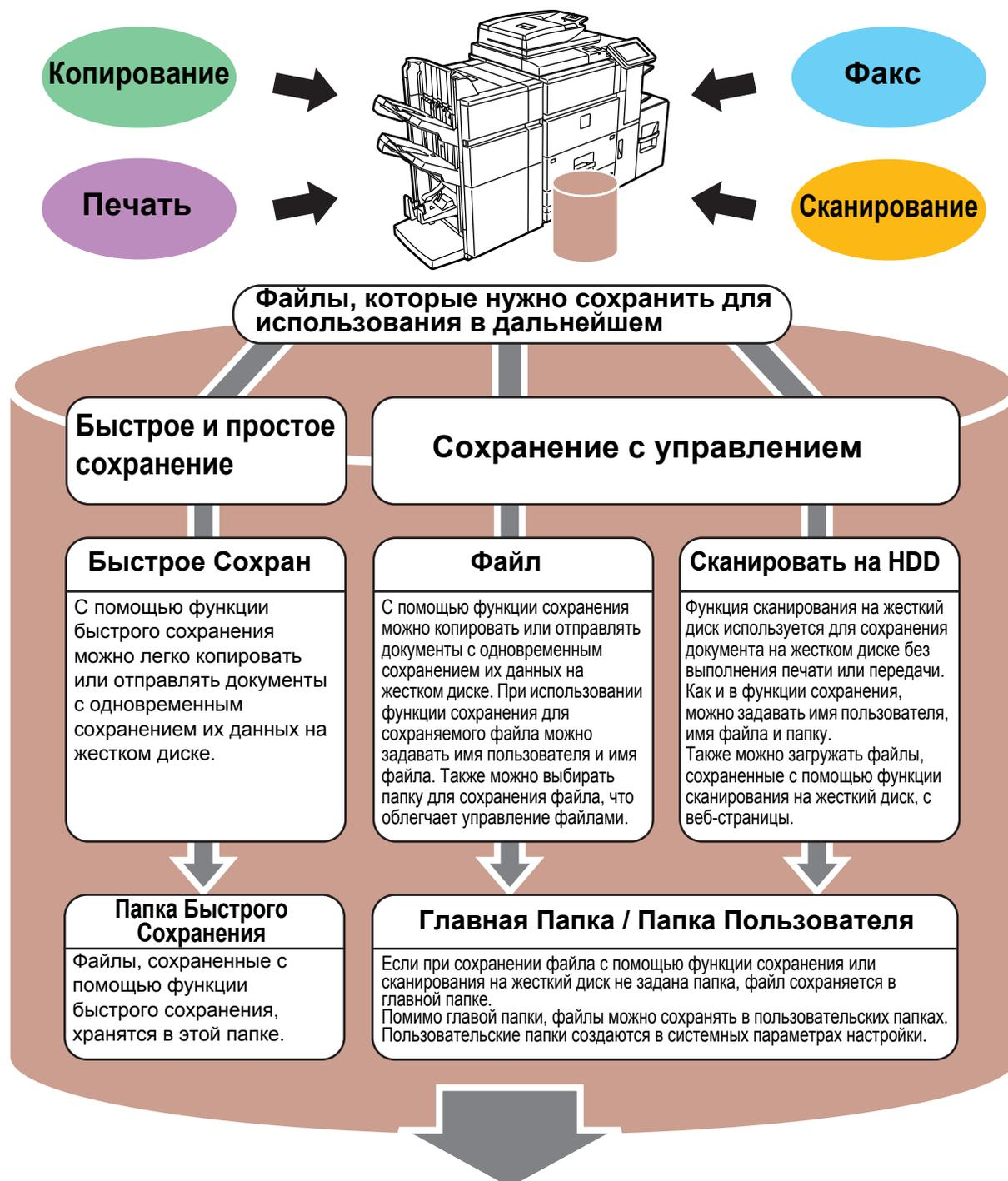
Сохраненные файлы можно в любой момент распечатать или передать. Передача файлов, сохраненных с помощью драйвера принтера, невозможна. (Файл можно передать, если изменить значение параметра "Формат преобразования" на "RGB".)
