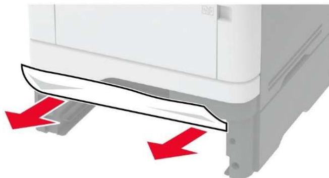
Рисунок 34 – Извлечение замятой бумаги.
