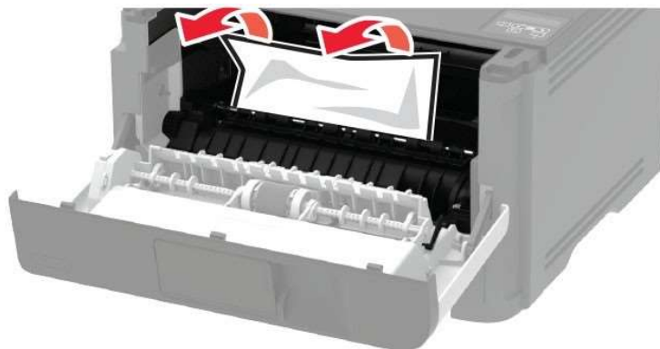
Рисунок 30 – Извлечение замятой бумаги
