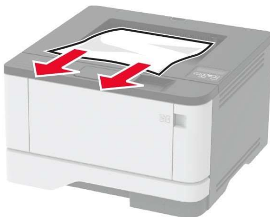
Рисунок 18 – Извлечение замятой бумаги в стандартном приемном лотке.
