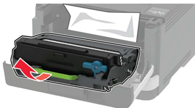
Рисунок 21 – Извлечение блока формирования изображения.
