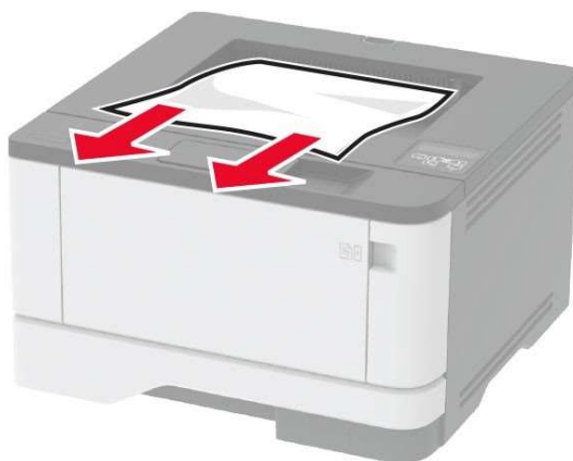
Рисунок 18 – Извлечение замятой бумаги в стандартном приемном лотке.
