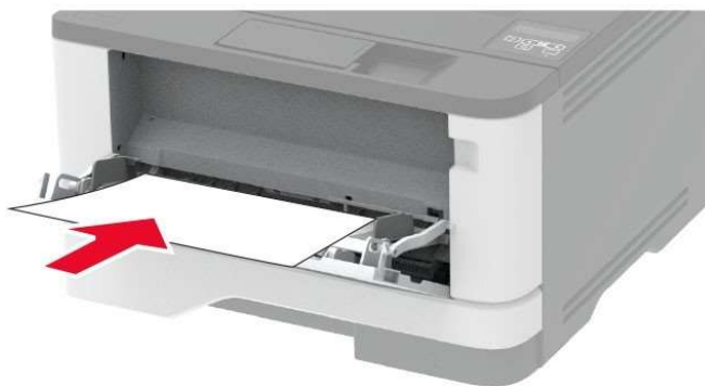
Рисунок 26 – Загрузка бумаги в многоцелевое устройство подачи.
