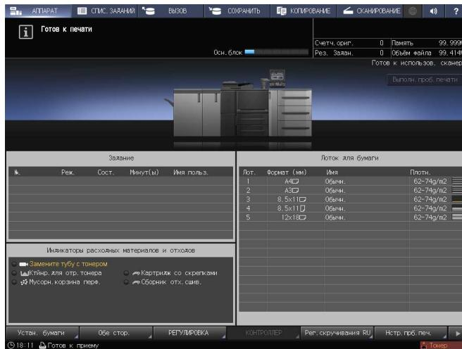
В случае, если подача тонера закончится и в бункере для тонера, то в области [Индикаторы расходных материалов и отходов] появятся сообщения, отображаемые красным цветом: [Нет тонера/Добавьте тонер] и [Тонер израсходован. Замените тубу с тонером]. Для замены **тубы с тонером** выполните описанную ниже процедуру.
