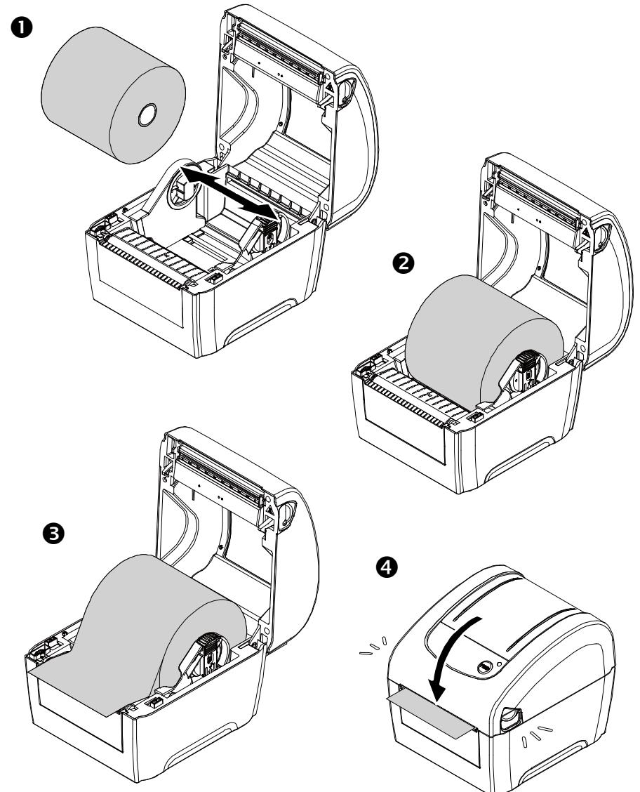
Loading External Media/安装外部进纸标签/安装外部进纸标签/外部メディアの読み込み/
