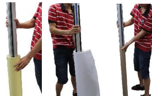
5. Разместите рулон прозрачной самоклеящейся пленки и пустую гильзу (для намотки подложки) на верхних валах, ламинируемый материал и пустую гильзу (для намотки готового изделия) на нижних валах и выровняйте их друг относительно друга используя линейки на валах.
