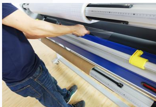
7. Поднимите вал, повернув ручку.
