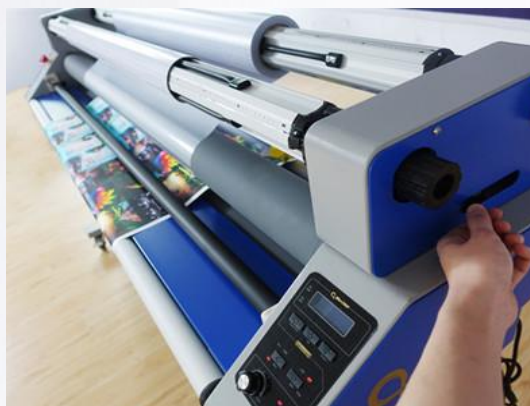
7. Поднимите вал, повернув ручку.
