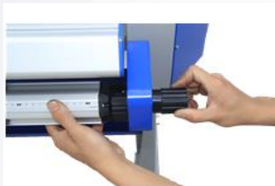
13. Отрегулируйте натяжение в зависимости от материала.
