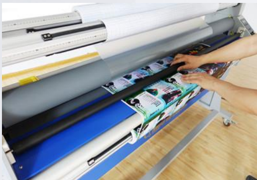
12. Опустите прижимной вал чтобы зафиксировать отпечаток.
