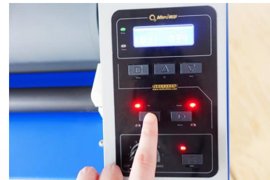
17. В прямом режиме нажмите «Run» для ламинирования. Регулятором установите нужную скорость. В обратном режиме нажмите «Stop» (педаль) для ламинирования.
