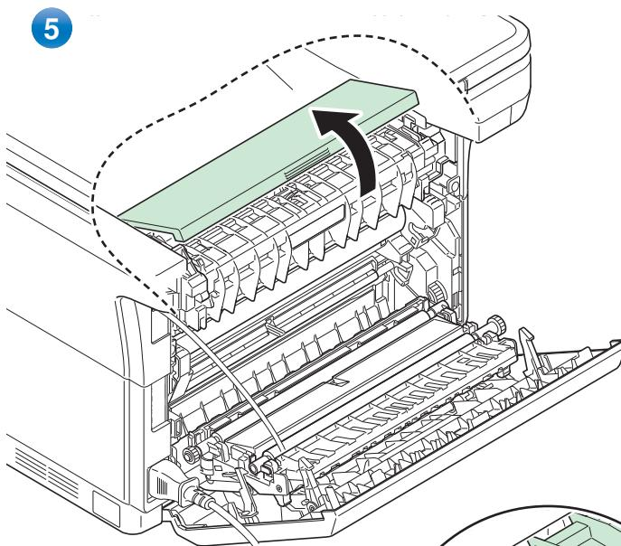
**ПРЕДУПРЕЖДЕНИЕ** Термоблок, установленный внутри аппарата, очень горячий. Во избежание ожогов не дотрагивайтесь до него.
