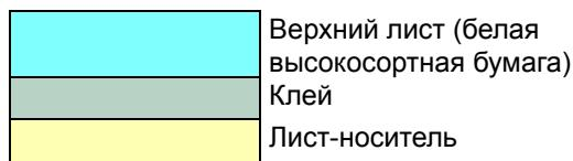
Бумага этикетки имеет структуру, состоящую из трех слоев, как показано на схеме. Верхний лист печатается. Клейкий слой состоит из чувствительного к давлению клейкого вещества. Лист-носитель (его также называют линейным или подкладочным листом) удерживает этикетки до использования. Из-за сложности своего состава этикеточная бумага с kleenой подкладкой наиболее подвержена проблемам при печати.
