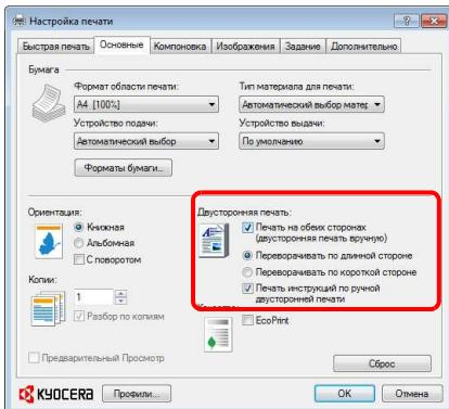
Выберите **Переворачивать по длинной стороне** для переплета на длинной стороне или **Переворачивать по короткой стороне** для переплета на короткой стороне. Для получения инструкций выберите **Печать инструкций по ручной двусторонней печати**.
