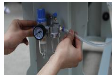
3. Подключите трубку (от компрессора) к воздушному входу водно-масляного сепаратора.
