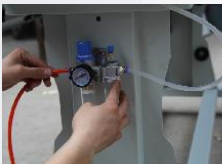
4. Подключите трубку (от компрессора) к воздушному входу водно-масляного сепаратора.
