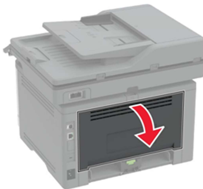
Рисунок 33 – Открытие задней дверцы.
