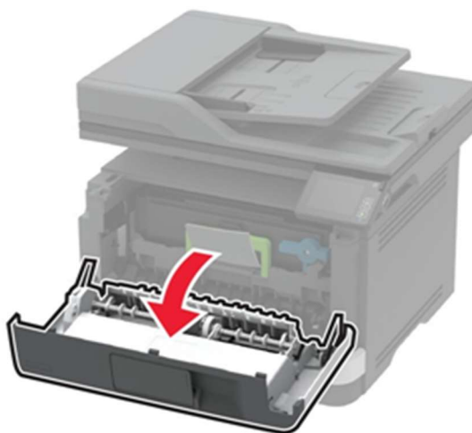
Рисунок 22 – Открытие передней дверцы.
