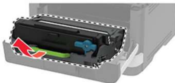
Рисунок 8 – Извлечение блока формирования изображения.
