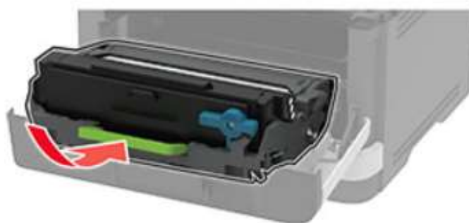
Рисунок 7 – Установка блока формирования изображения в МФУ.
