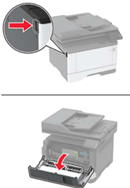
Рисунок 5 – Открытие передней крышки.
