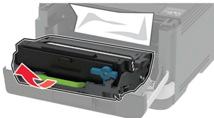
Рисунок 23 – Извлечение блока формирования изображения.
